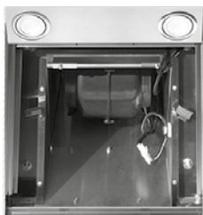
Ryc. 11. Wymiana filtrów węglowych montowanych tuż przed turbiną (kasety)
